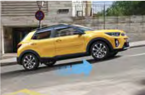
Cornering Brake Control (CBC). Cornering Brake Control (CBC) is ontwikkeld om je te helpen bij het stabiel remmen in bochten. Afhankelijk van snelheid en grip verdeelt CBC de remkracht over de binnenste en buitenste wielen. Zo blijft de Stonic ook bij het remmen in bochten stabiel op koers.
