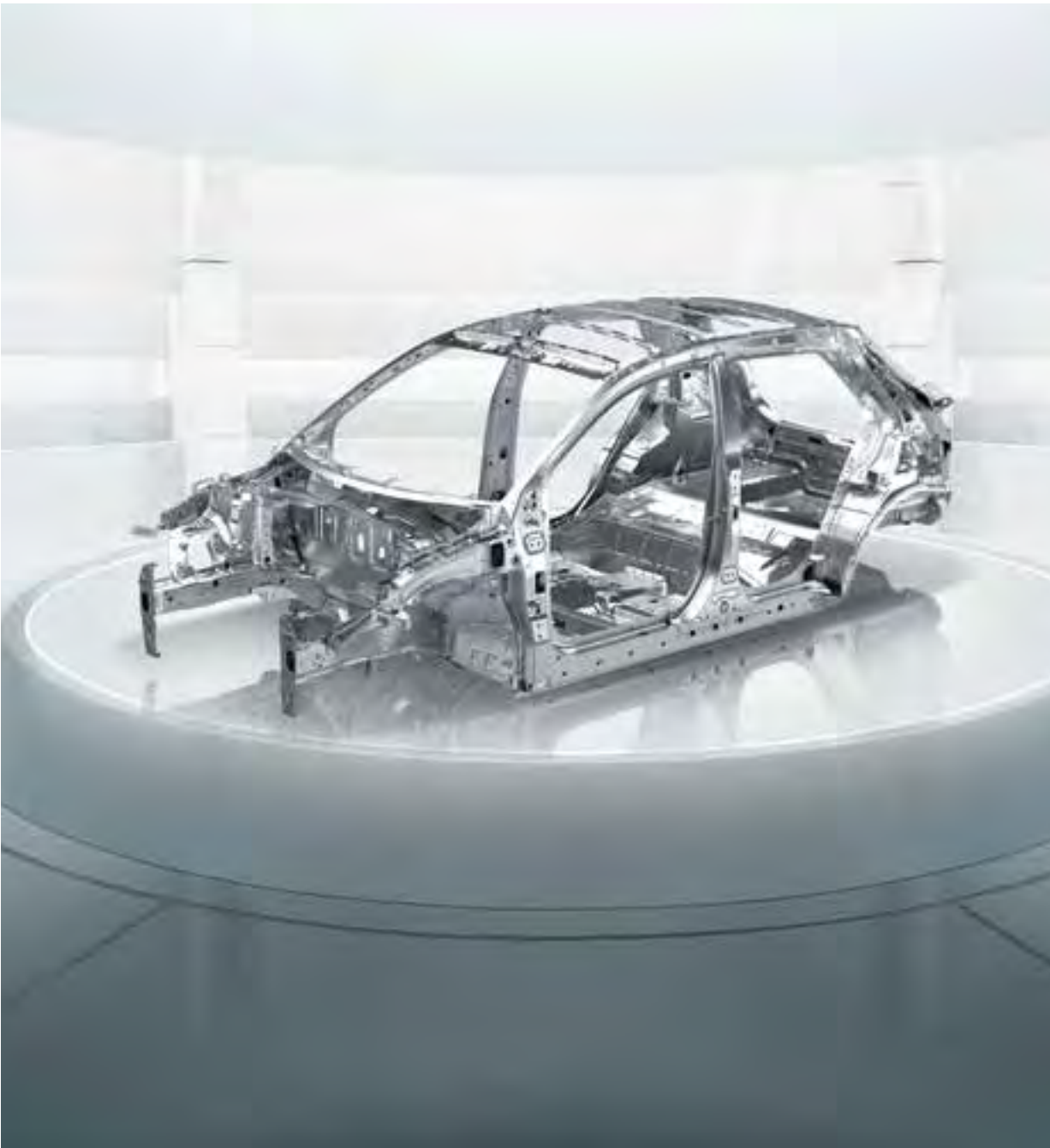
Geavanceerd hoogwaardig staal. De carrosserie bestaat voor een groot deel uit Advanced High Strength Steel (AHSS). Dat maakt de body van de Stonic uitzonderlijk sterk: de beste basis voor optimale botsveiligheid en een goede wegligging.
