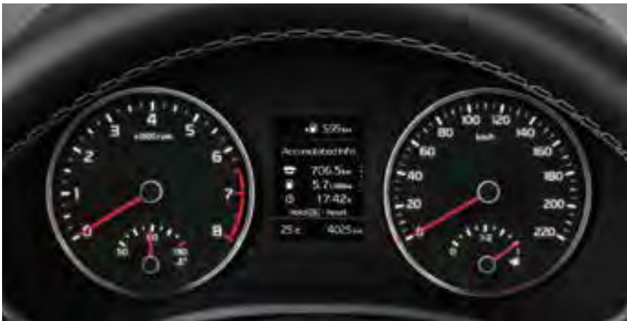
4.2" supervision cluster. S Helder, overzichtelijk en naar wens instelbaar biedt het digitale scherm in het instrumentenpaneel een schat aan nuttige informatie, zoals ritgegevens, voertuiginformatie, buitentemperatuur en vorstwaarschuwing.
