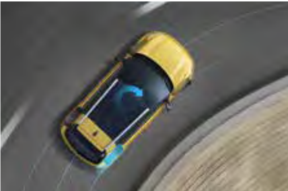
Cornering Brake Control (CBC). Cornering Brake Control (CBC) is ontwikkeld om je te helpen bij het stabiel remmen in bochten. Afhankelijk van snelheid en grip verdeelt CBC de remkracht over de binnenste en buitenste wielen. Zo blijft de Stonic ook bij het remmen in bochten stabiel op koers.
