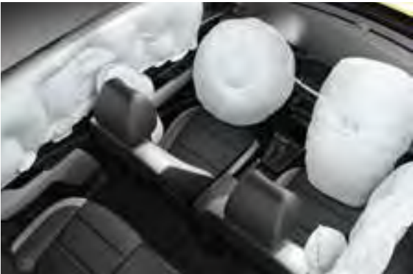
6 airbags. De Kia Stonic beschermt je met voor- en zijairbags voor de bestuurder en de voorpassagier, plus twee gordijnairbags links en rechts over de volle lengte van de cabine.
